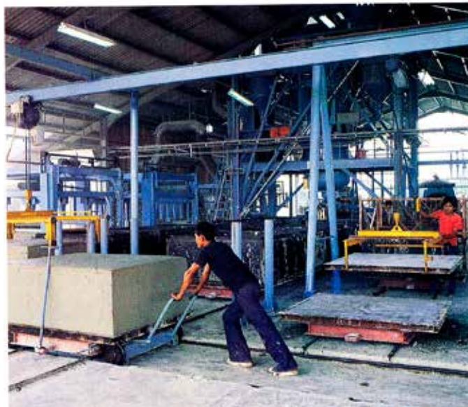
Gasbetonfabrikken på øen Batam i Indonesien blev opbygget under hensyntagen til størst mulig anvendelse af lokal arbejdskraft i den daglige produktion.
